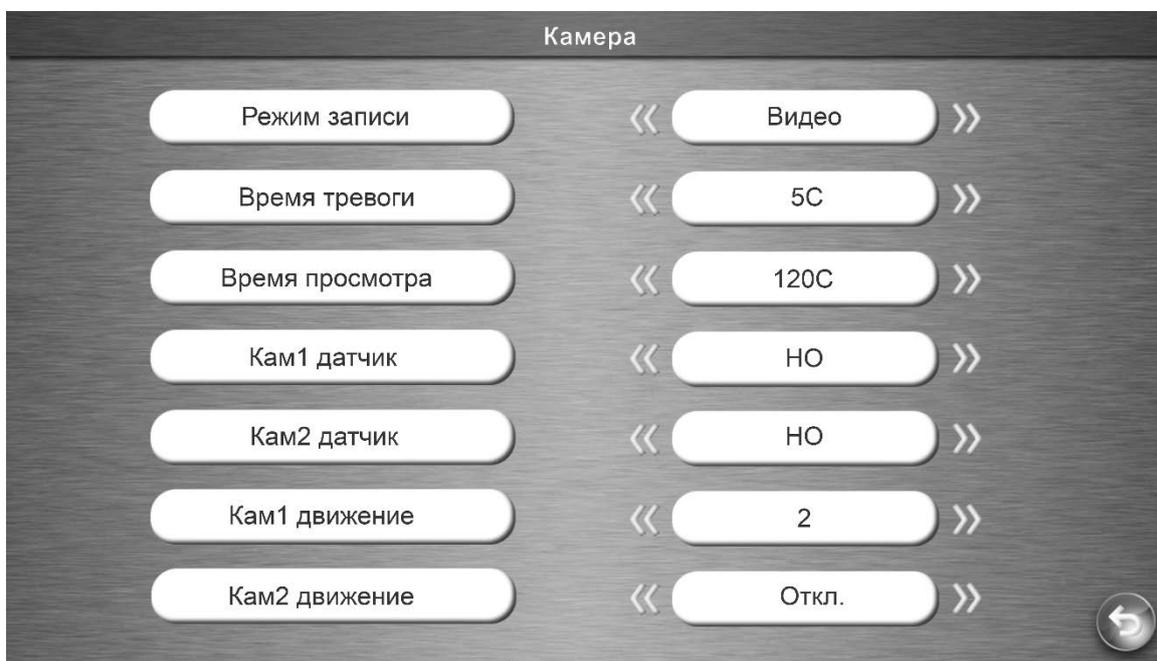
**Режим записи** – выбор типа записи с дополнительных камер по детекции движения или по срабатыванию дополнительного датчика(Фото или Видео).
