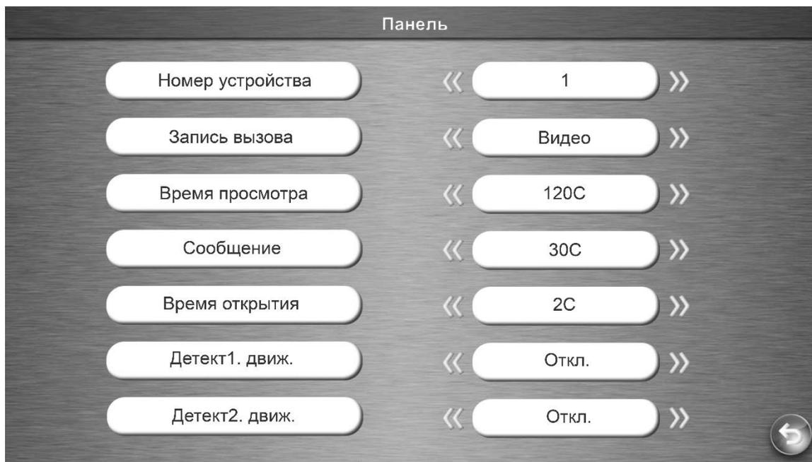
**Номер устройства** – при подключении нескольких мониторов по интеркому необходимо установить адрес устройства: 1 – основной монитор, 2 – 6 – дополнительные мониторы (см. ВОЗМОЖНОСТИ ПОДКЛЮЧЕНИЯ).
