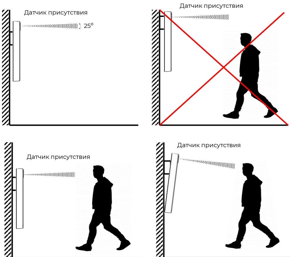
При использовании датчика присутствия нужно убедиться, что на расстоянии не менее 2 метров перед терминалом отсутствуют какие-либо препятствия (стены, перегородки, элементы турникета). При наличии препятствий, улавливаемых датчиком присутствия, терминал не будет переходить в энергосберегающий режим.
