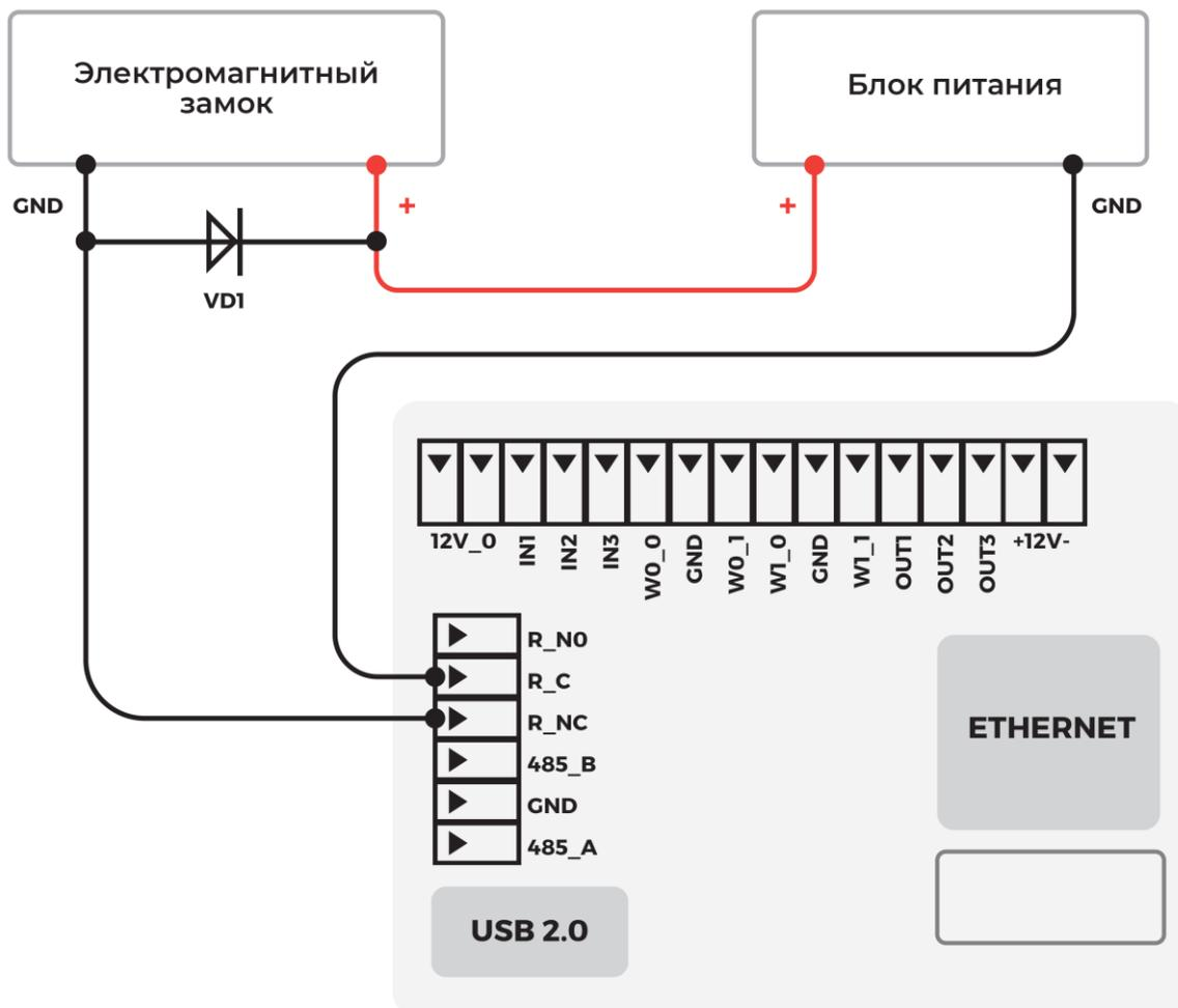
Подключение двух терминалов к одному электромагнитному замку осуществляется в соответствии со схемой ниже.
