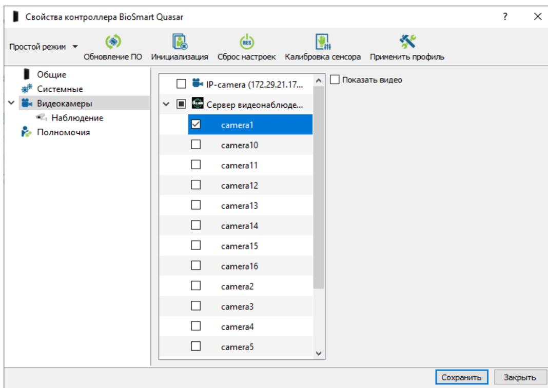
На вкладке можно выбрать сервер видеонаблюдения, на котором будет храниться видео, и камеру. Видеофрагменты с выбранной камеры будут привязаны к событиям идентификации на терминале BioSmart Quasar. Фрагменты видео можно просматривать в разделе «**Журналы**».
