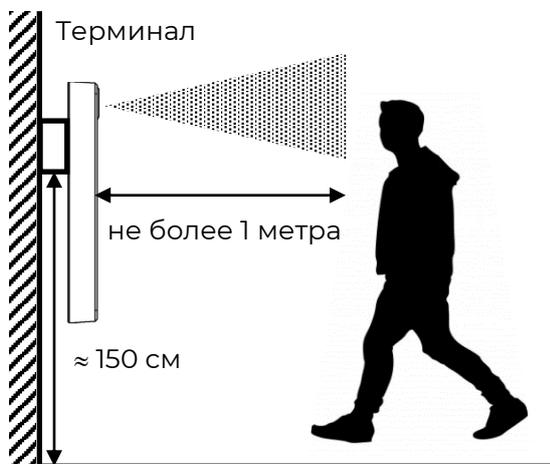
Вариант монтажа под наклоном подходит при работе с пользователями, рост которых сильно отличается друг от друга. Чтобы попасть в объектив камер, пользователь может встать подальше (не более 1 метра) или подойти поближе.
