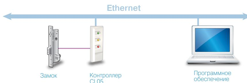
Замок управляется в потенциальном режиме. Для нормально закрытых замков разблокировка производится подачей управляющего напряжения, для нормально открытых замков – снятием управляющего напряжения.
