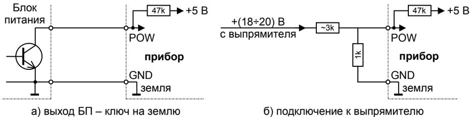
Рис. 2. Примеры монтажа входа POW (контроль сети 220 В)
