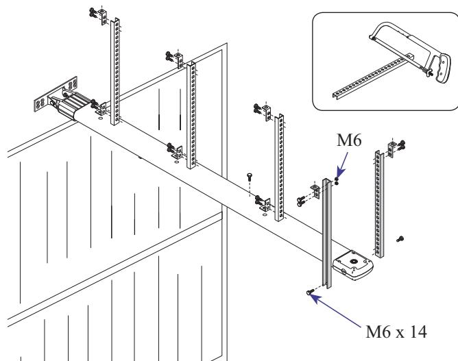
3) Закрепите направляющий профиль к потолку, используя соответствующие болты.
