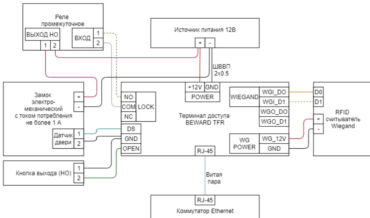
Если терминал доступа BEWARD выступает в роли считывателя на точке прохода, то при успешной идентификации сотрудника на терминале, от терминала на сторонний контроллер доступа может быть передан заранее закреплённый за сотрудником Wiegand-код, идентифицирующий сотрудника в стороннем контроллере (см. руководство по эксплуатации терминалов доступа Beward TFR на сайте [beward.ru](http://beward.ru)). Для этого необходимо задействовать разъёмы Wiegand выход на терминале:
