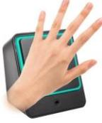
**5** Допустимы повороты ладони на угол **до 90°** в плоскости, параллельно сканеру
