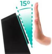
**6** Допускаются углы наклона ладони относительно плоскости **не более 10-15°**
