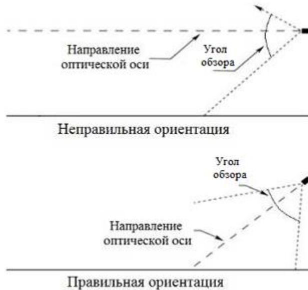
Рисунок 2 – Установка извещателя по отношению к горизонту
