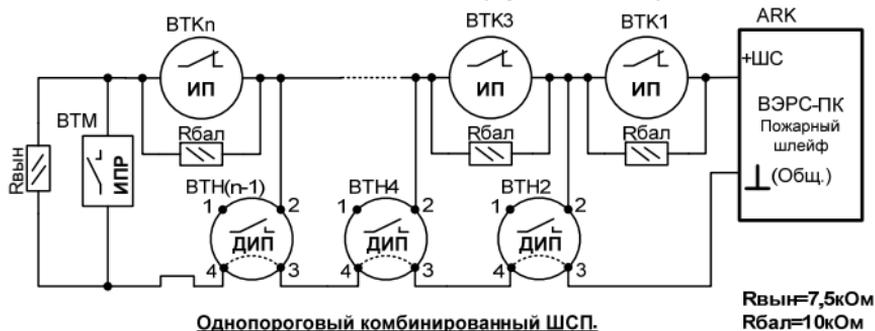
Рисунок.Б5. Комбинированная схема однопорогового ШСП.
