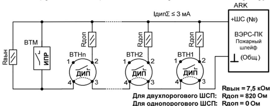
Для извещателей производства ГК «Рубеж», подключенных в двухпороговый ШСП  $R_{доп}=470 \text{ Ом}$ .
