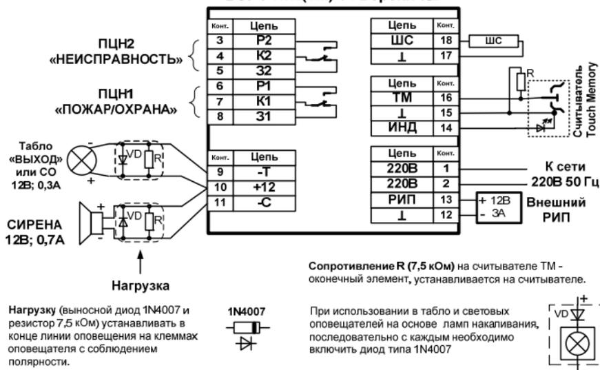
Рисунок.Б1. Схемы внешних соединений прибора
