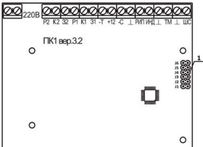
Рисунок Б2. Вид на клеммы и разъемы для внешних подключений
