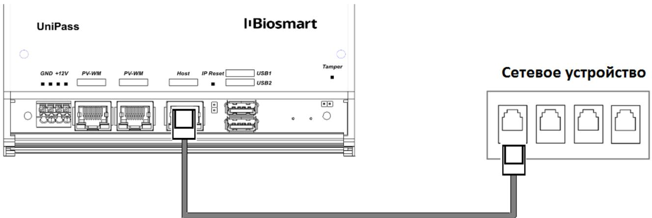
Рисунок 9 - Схема подключения к сети Ethernet
