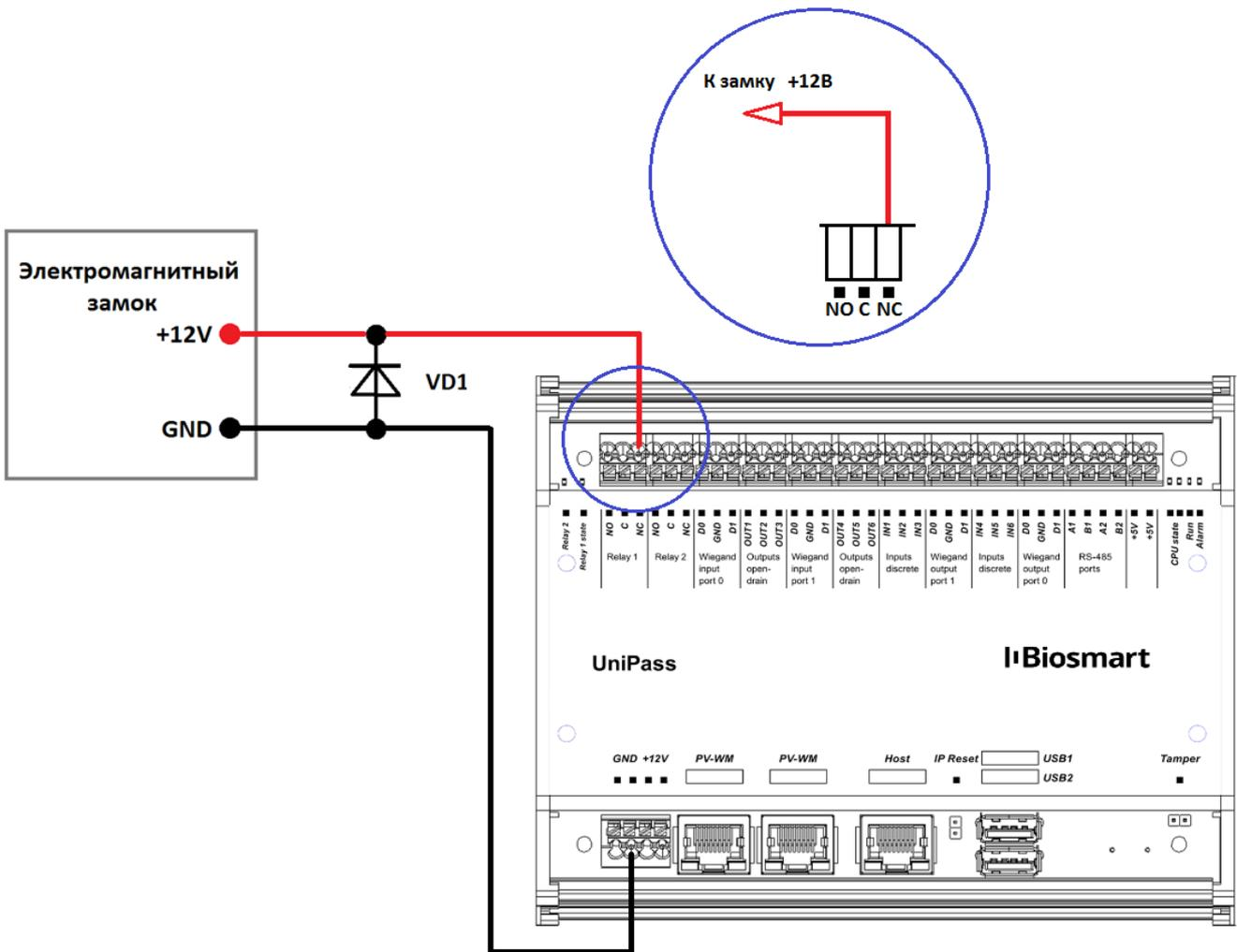
Рисунок 13 - Подключение электромагнитного замка без внешнего источника питания
