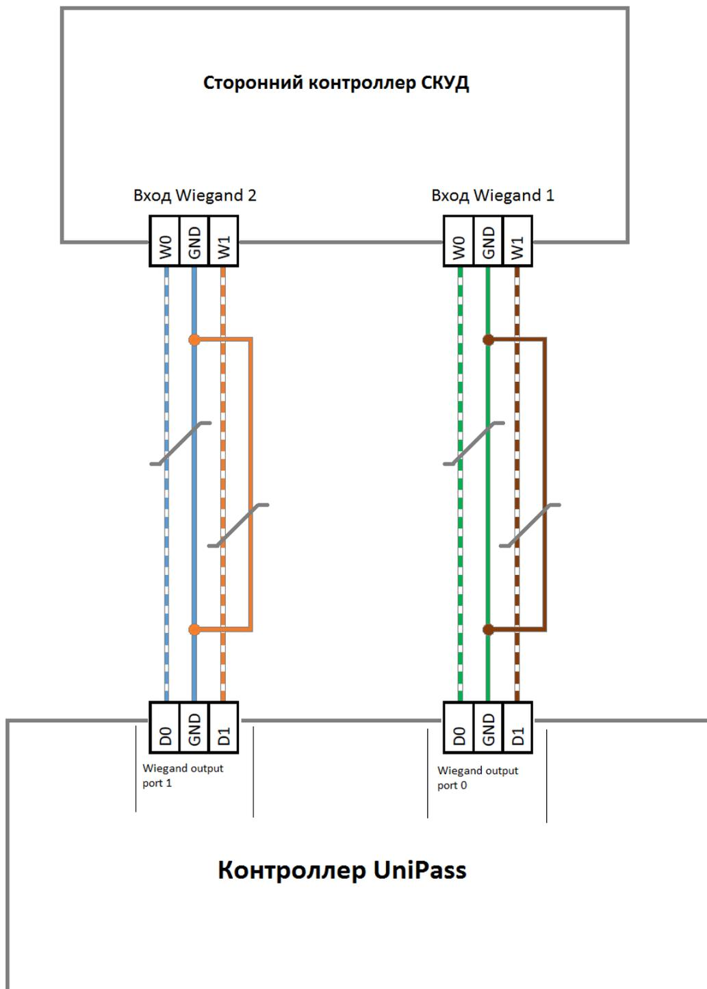
Рисунок 20 - Подключение контроллера к сторонней СКУД по Wiegand
