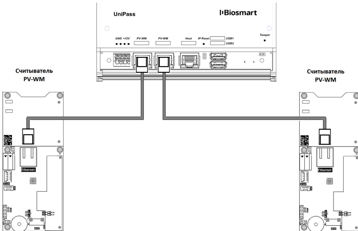
Рисунок 11 - Схема подключения к считывателям BioSmart PV-WM
