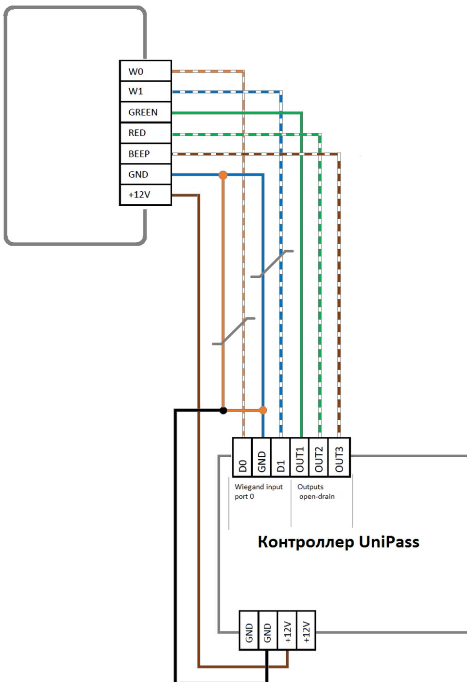
Рисунок 18 - Подключение считывателя с нарушением гальванической развязки.
