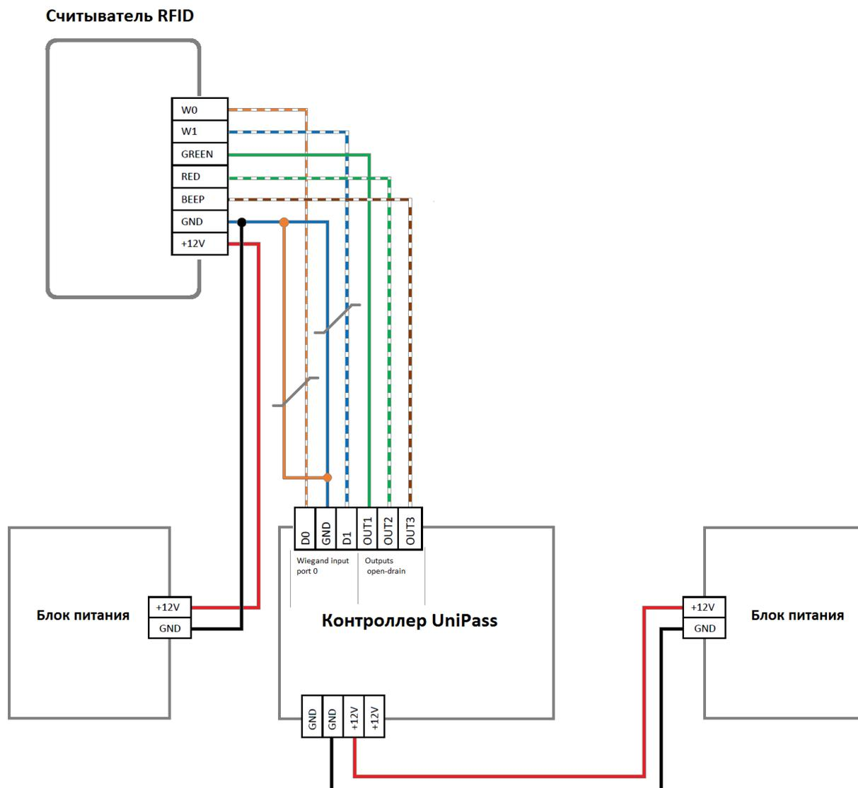
Рисунок 19 - Подключение считывателя с сохранением гальванической развязки.
