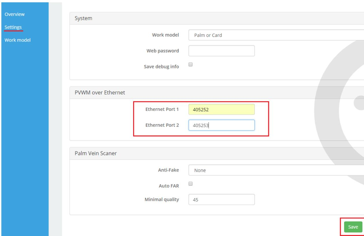
Рисунок 24 - Запись серийных номеров считывателей.
