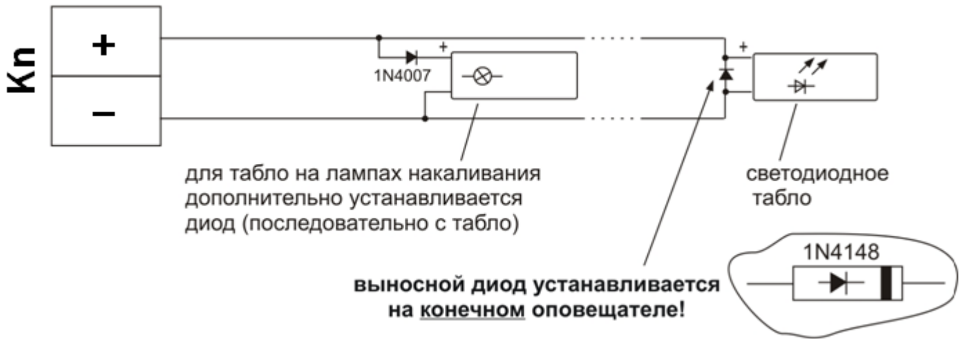
Рис. 10. Схема подключения нескольких световых табло
