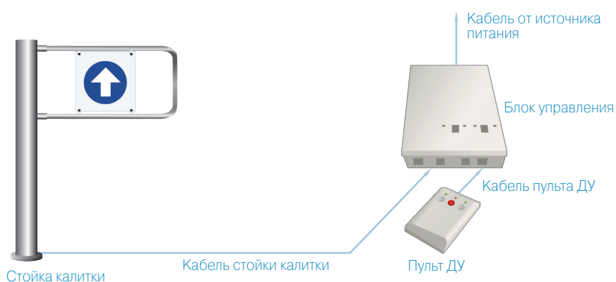
Схема подключения калитки PERCo-WMD-05S
